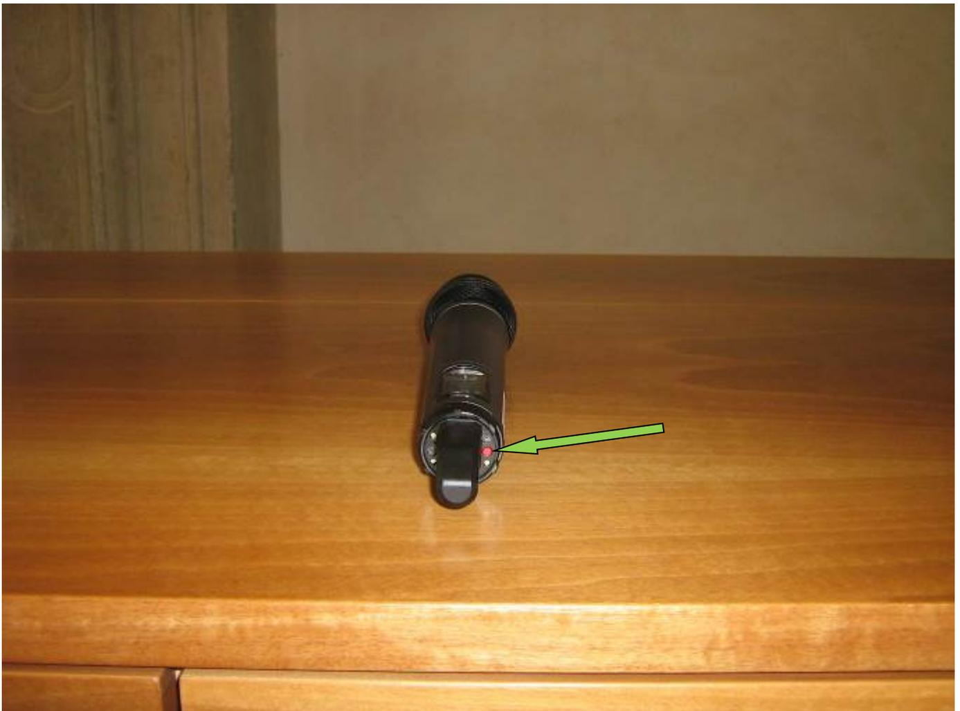
Per sostituire le batterie sbloccare la parte superiore da quella inferiore del microfono ruotandole in direzioni opposte
